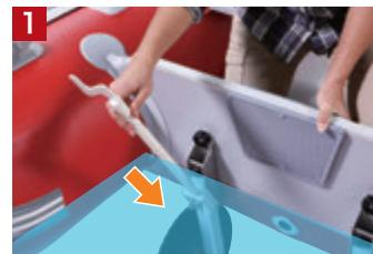
専用スティックで留め金を押し込み、固定
