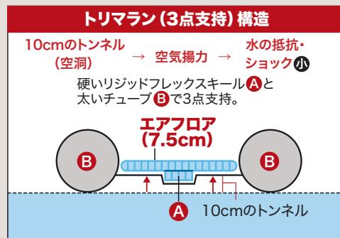
左右の太いチューブとエアキールで艇体を3点支持。船底と水面の間にトンネル(空洞)を形成。この形が水面との接触抵抗を減少させ、高速でショックのない安定した走航を生みます。抵抗が少ないので、2馬力エンジンであっても大型艇をスムーズに走らせます。JES-326、336とJES-383、404は基本的な構造は同一ですが、ボトム形状(船底とエアフロア)が多少異なります。
