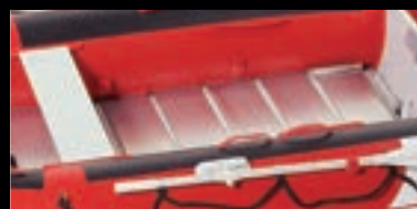
アルミロールアップフロアをエアフロアに重ねた様子
