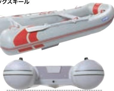
高さ10cmのトンネルで水の抵抗を抑えるJ-キャットの船型
