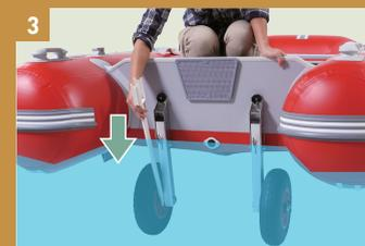
そのまま支柱が垂直になるまで押し込むと、自動的に留め金が作動し固定されます。
