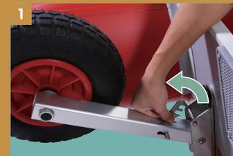
支柱を固定している留め金を外します。ホイールを少し引き上げると楽に外れます。
