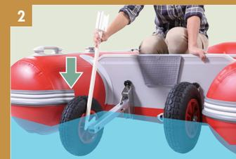
水面に浮いたホイールの車輪軸を専用スティックで押し込みます。ここでも手は濡れません。
