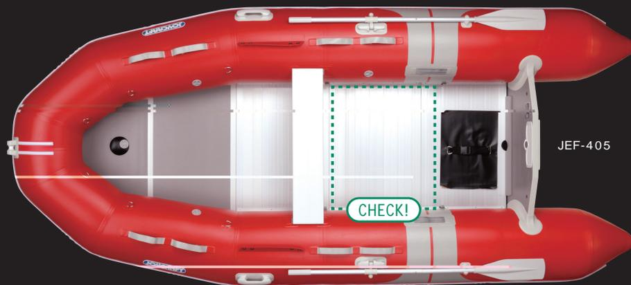
圧力を受けても曲がらないアルミフロアなので、エアキールが張り出し、しっかりしたV型船型を形成。
