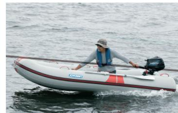
ビッグスターンのレッドキャップの2馬力走航。体重70kgの操縦者を乗せ、スピード溢れる走りを見せています(約15km/h)。
