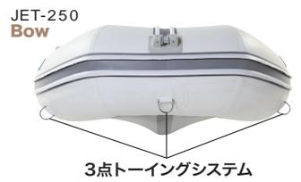
ボトムはエアキールが設定されるため、非常に安定した走航を得られます。また紫外線に強い素材の採用で、船上での長時間放置にも耐えます。
