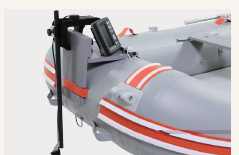
バウのモーターマウントは魚探モニター & 振動子取付用としても使用可能。
