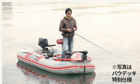
バウのモーターマウントは魚探モニター & 振動子取付用としても使用可能。
