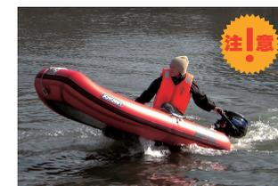
**注意!** スターンのモーターマウントには、決して2馬力以上の船外機を搭載しないで下さい。エンジンがボートの外にセットされ、写真のようにバウアップして危険です。
