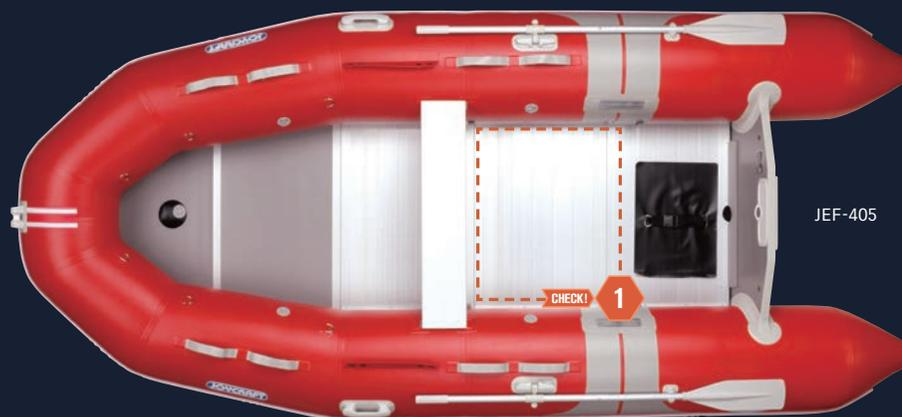
圧力を受けても曲がらないアルミフロアなので、エアキールが張り出し、しっかりしたV型船型を形成。
