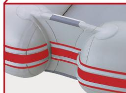
パウのボードは18mmの厚さを確保。エレキモーターを確実にスマートに装着できます。
