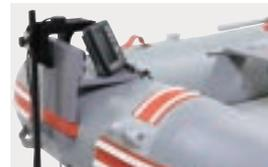
パウのモーターマウントは魚探モニター&振動子取付用としても使用可能。
