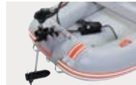
パウにフットコントローラー付きのエレキモーターをセットした例。
