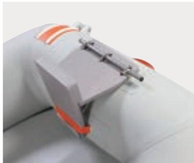
パウにモーターマウント (MMT) 取り付け用の金具を設定。
