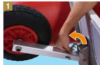
1 支柱を固定している留め金を外します。
