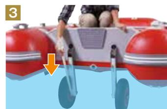
3 支柱を押し込むだけで、自動的に固定されます。
