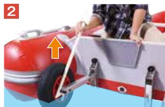
2 浮力で自然に浮くホイールの車輪軸に、スティックを引っかけて持ち上げます。
