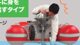
手を水中に入れて固定を解除し、ホイールを跳ね上げる。身を乗り出す作業を伴い危険。
