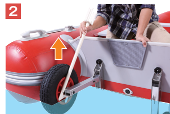
浮力で自然に浮くホイールの車輪軸に、スティックを引っかけて持ち上げます。
