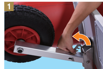
支柱を固定している留め金を外します。
