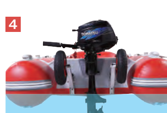
引き上げてもランチングホイールはエンジンにまったく干渉しないスマート設計です。
