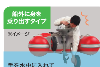
船外に身を乗り出すタイプ ※イメージ 手を水中に入れて固定を解除し、ホイールを跳ね上げる。身を乗り出す作業を伴い危険。
