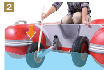
水面に浮いたホイールを専用スティックで押し込みます。ここでも手は濡れません。
