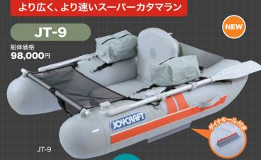
JTシリーズは、カタマラン(双 モーター 胴) タイプのフローター。水線 マウント 長が長いので直進性は抜群で す。シート背もたれ後方の大 スペースはエアフロア付きで 浮力も高く、様々な荷物の積載 が可能。フローターフィッシン グの世界がグンと広がります。
