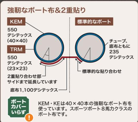
ボートカバーいらず! KEM・KEは40×40本の強靱なボート布を使っています。スポーツボート8馬力クラスのボート布です。
