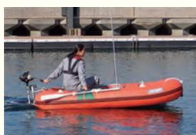
オプションのモーターマウント (MMT) を取り付ければ、写真のように1.2馬力エンジンやエレキなどで機走可能に。
