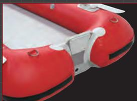
スモルトランサムにエンジンを付け、機走での移動も可能。
