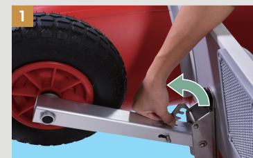
支柱を固定している留め金を外します。ホイールを少し引き上げると楽に外れます。
