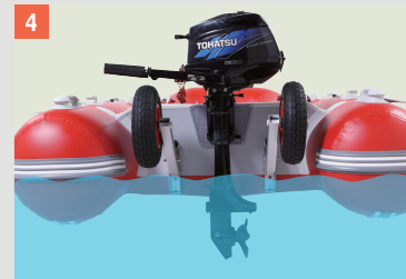
引き上げてもランチングホイールはエンジンにまったく干渉しないスマート設計です。
