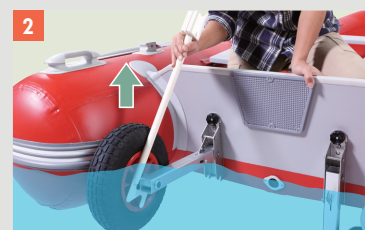
浮力で自然に浮くホイールの車輪軸に、スティックを引っかけて持ち上げます。
