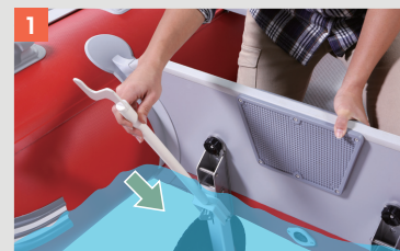
専用スティックで支柱の留め金を押し込み、固定を解除。水中に手を入れる必要はありません。
